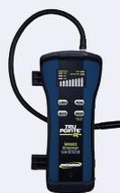
L'exposition du capteur à un flux stable de fluides frigorigènes hautement concentré endommagera le capteur ou en réduira sérieusement la durée de vie, celle-ci dépendant directement à la quantité de fluide frigorigène qui le traverse. Les détecteurs infrarouges comme le **Tru Pointe IR** sont insensibles aux expositions importantes et répétées de gaz réfrigérants, ils ont donc une durée de vie bien plus importante (jusqu'à 10 ans).
