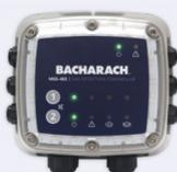
La centrale **MGS-402** centralise jusqu'à 2 capteurs **MGS 400** connectés en série avec une communication Modbus. Un bandeau LED indique l'état de chaque détecteur d'un seul coup d'œil : alimentation, défaut et alarme. Trois relais d'alarmes librement affectables sont disponibles pour les asservissements.
