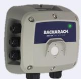
Modèle autonome IP41 ou IP66 avec sorties relais, alarme sonore intégrée 72 dB(A) et sortie linéaire 4-20 mA & numérique Modbus RTU. Peut être utilisé de manière autonome ou avec une centrale.
