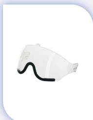
Les lunettes de protection sont manoeuvrables depuis l'extérieur par deux leviers (pour les gauchers et les droitiers). Leurs deux positions de réglage s'adaptent à chaque forme de visage, même en cas de port de lunettes de vue. Le bord matelassé assure un port confortable (Dräger HPS 7000 PRO uniquement). Conforme à la norme EN 14458 : 2004 (+, - 40 °C, T, N, K, AT, R, E3)
