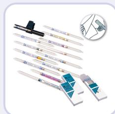
Les tubes dosimétriques ou dosi-tubes sont d'excellents dispositifs pour mesurer les concentrations de gaz toxiques sur une durée moyenne d'exposition. Grâce à ce système simple et économique, on peut facilement obtenir les concentrations quotidiennes de gaz et évaluer le milieu de travail en les comparant avec les limites d'exposition recommandées.
