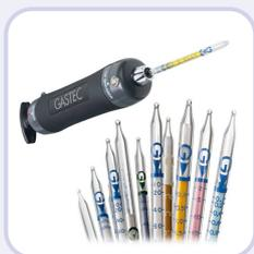
Les tubes réactifs colorimétriques, avec utilisation d'une pompe manuelle, permettent des mesures instantanées des concentrations gaz. Avec près de 500 gaz référencés et de nombreuses plages de mesures différentes, ils constituent une solution opportune dans bien des domaines pour mesurer avec précision la présence de gaz ou vapeurs toxiques ou asphyxiants.
