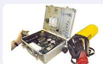
Le kit AIR-QUAL, une mallette type Pelican avec régulateur de débit, manomètre, contrôle de la température et de l'hygrométrie, et 5 emplacements pour la mesure simultanée de 5 gaz (livré avec 5 tubes réf. 2AG, 1A, 109AD, A et 6AG).
