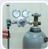
Le **kit standard STD-300** qui contient le régulateur de débit avec manomètre et le porte-tube. Ce dispositif nécessite une mesure pour chacun des gaz à détecter.
