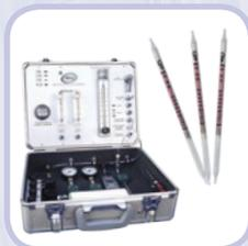
**Les Tubes Airtec** permettent à quiconque de mesurer de façon simple, rapide et quantitative la qualité de leur air respirable comprimé (bouteilles, adduction d'air). Facile d'utilisation, le Tube Airtec représente une méthode précise de contrôle et d'analyse du CO, du CO<sub>2</sub>, de la vapeur d'eau, des oxydes d'azote et des vapeurs d'huile.
