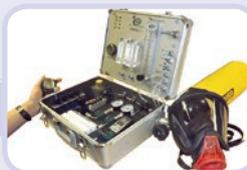
Le **kit AIR-QUAL**, une mallette type Pelican avec régulateur de débit, manomètre, contrôle de la température et de l'hygrométrie, et 5 emplacements pour la mesure simultanée de 5 gaz (livré avec 5 tubes réf. 2AG, 1A, 109AD, A et 6AG).
